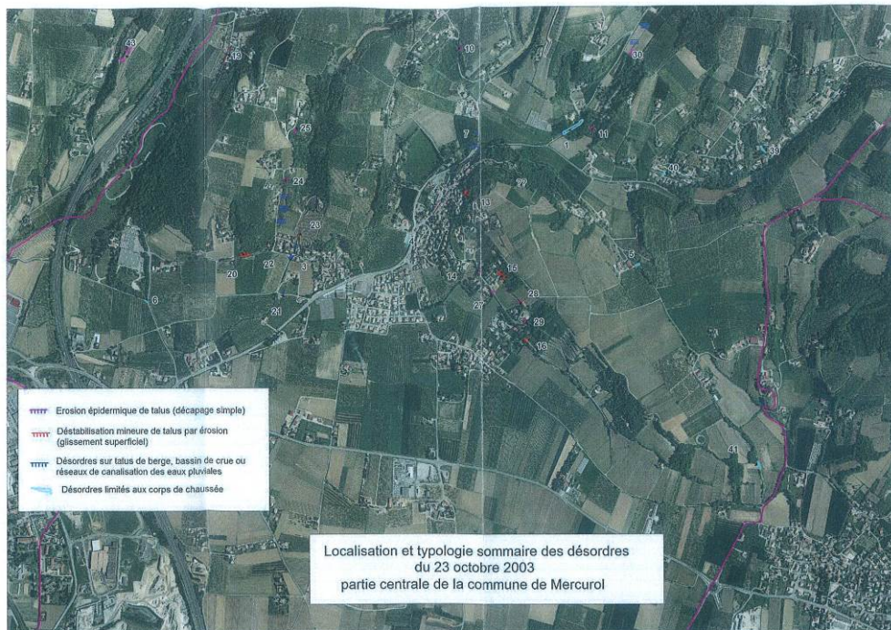
Figure 6 : Localisation et typologie des désordres de terrain subis sur le centre de la commune (partie sud des collines) PRGM/RP-63487-FR
